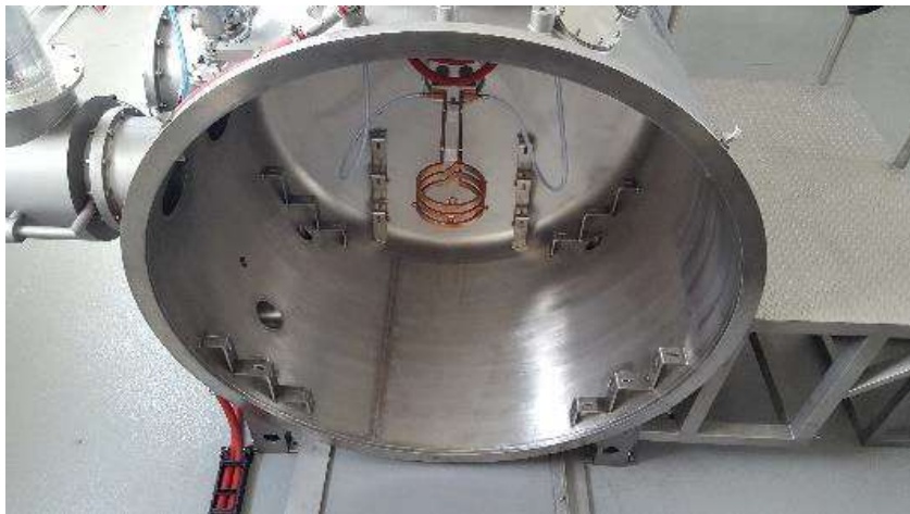
Obr. 2.4.1 Část pecní ochranné komory s instalovaným induktorem pro tavení oxidů kovů [23]
