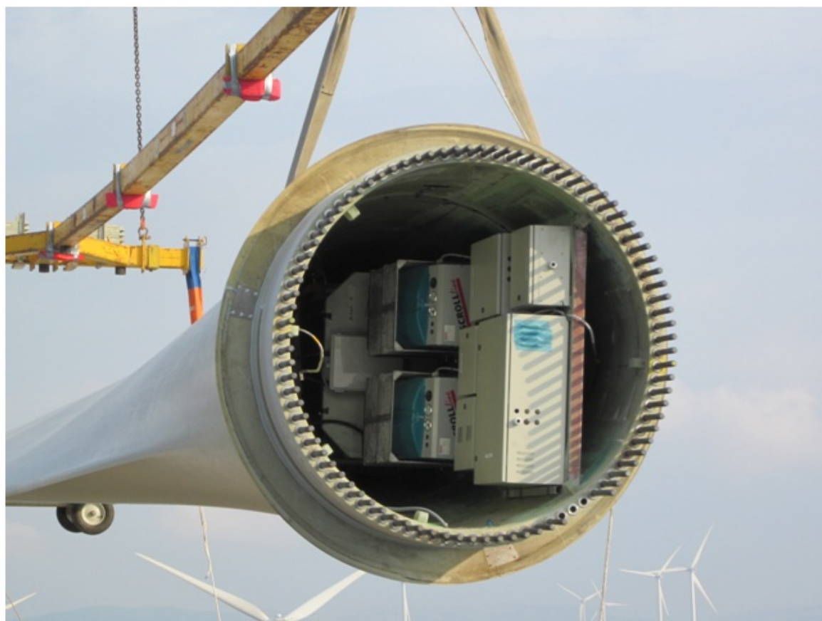
Obrázek 2.3: Měřicí systém umístěný uvnitř lopatky větrné turbíny
