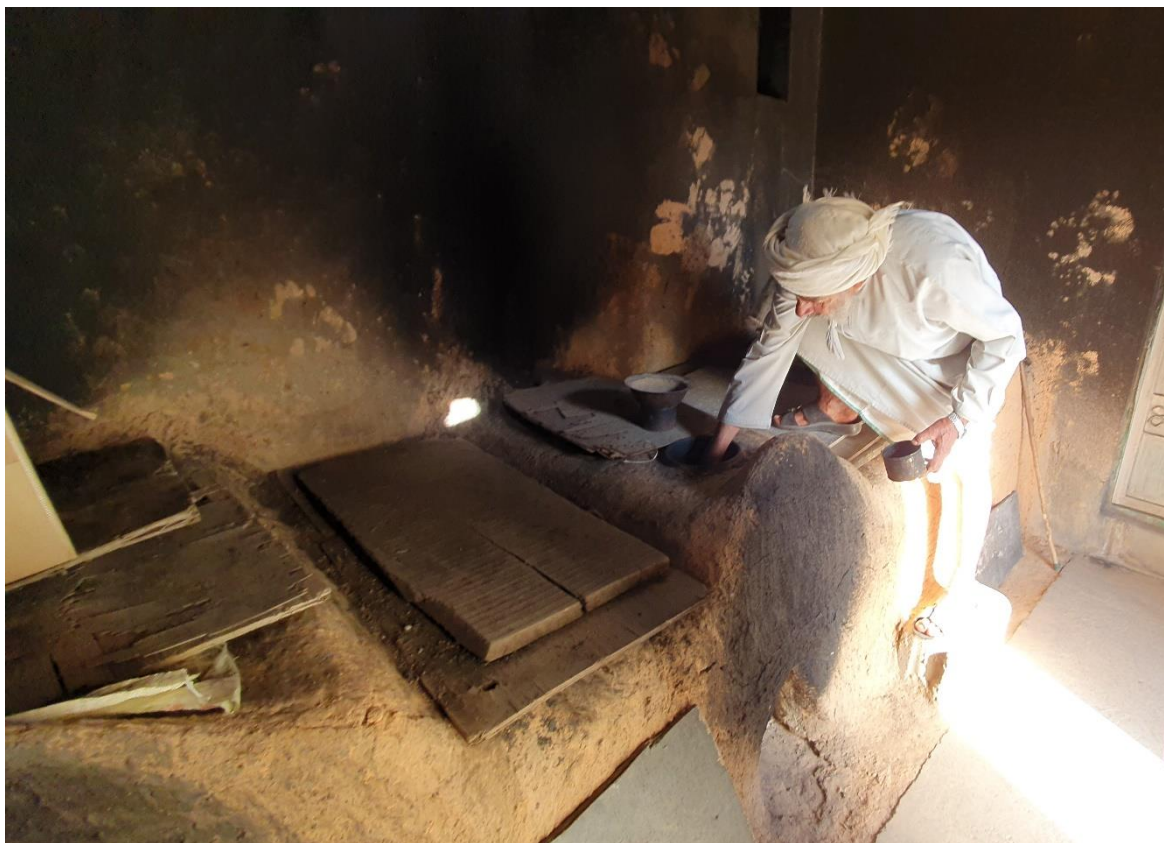
Obr. č.2: Tradičná hlinená pec higa , ktorá sa používa na výrobu ružovej vody.
