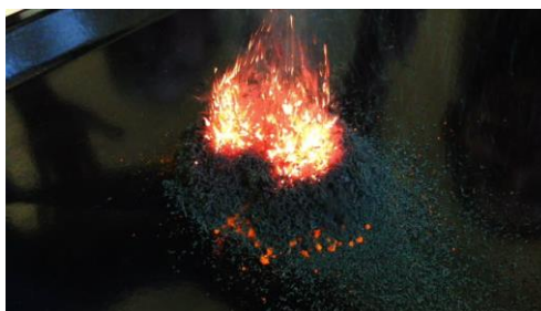
Obr. 6 Pokus „chemická sopka“, vznik oxidu chromitého 21
