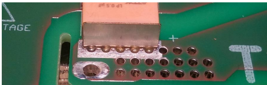
Obr. 8.4 Nedokonalost pájeného spoje kondenzátoru po zapečení
