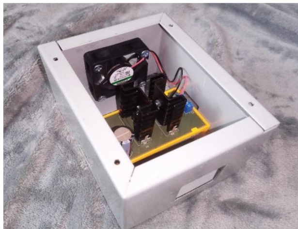
Obr. 6.8: Měnič ve stínícím krytu s dodatečným chlazením
