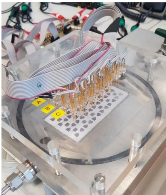
Obr. 26: Měřicí přípravek s kontaktovacím jehlovým polem.
