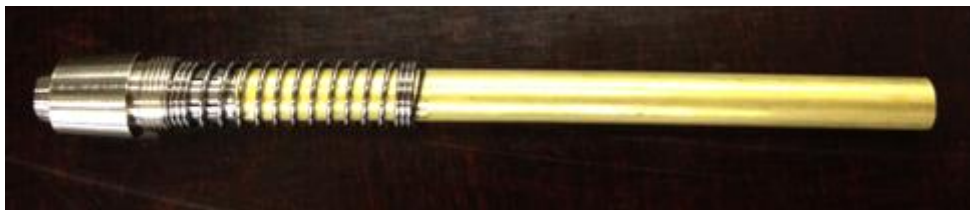
Obr. 3.8 Pružina s podložkou zalisovaná na trubce
