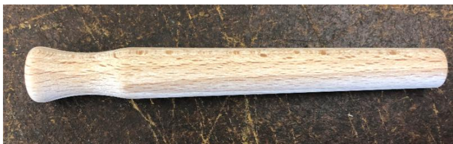
Obr. 3.11 Vysoustružený a obroušený kužel
