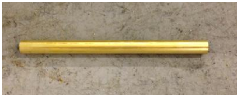
Obr. 3.4 Odjehlená nařezaná trubička
