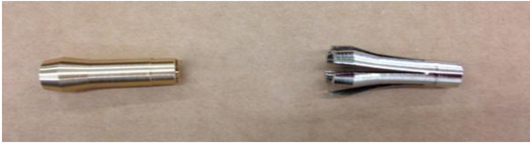
Obr. 3.5 Vysoustruhovaná kleštěnec vlevo a rozřezaný poniklovaná kleštěnec vpravo
