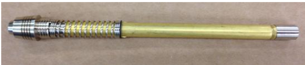
Obr. 3.9 Trubka se zalisovaným knoflíkem
