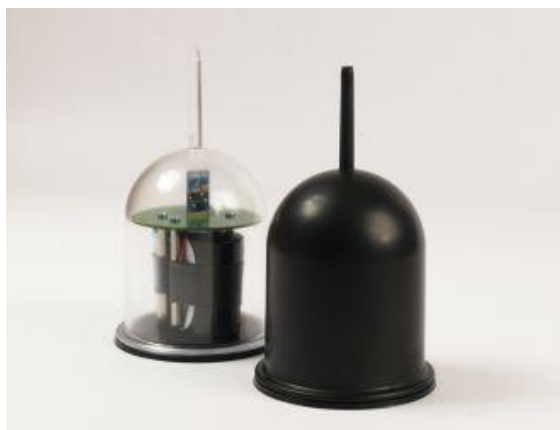
Obr. 3.4 Magnetické detektory umístované pod povrch vozovky, převzato z [46]
