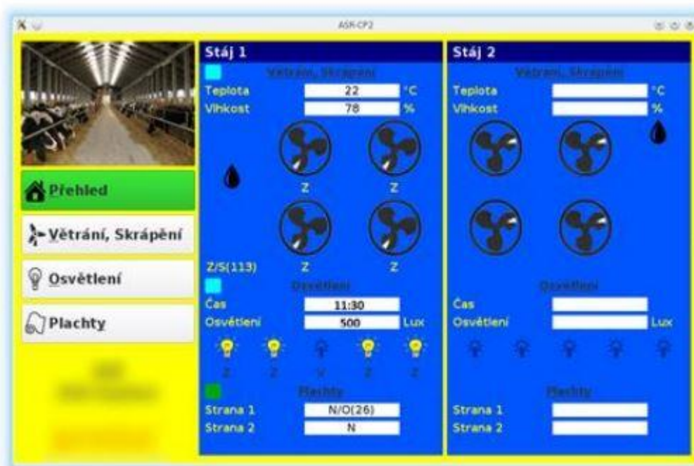
Obr. 1.6 Grafické prostředí počítačového programu pro řízení mikroklimatu, převzato z [25]
