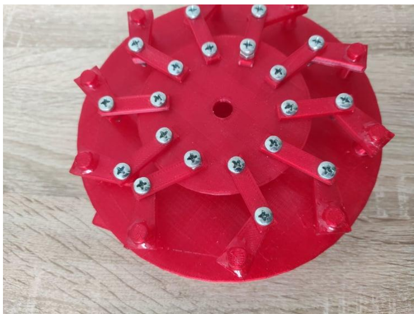
Obr.: 3.31 Původní víko s protočenou lopatkou
