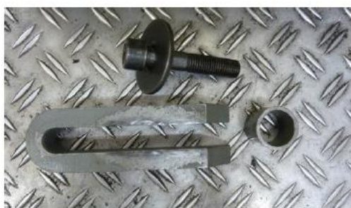
Obr 7.2. Nahrazení běžných šroubů rychlo upínkami
