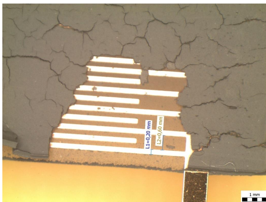
Obr. 5.9: Měření rozměrů elektrodových prstů na elementu CH210
