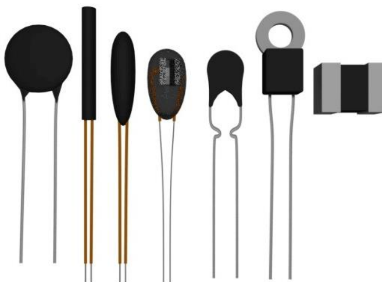
Obr. 2.2: Různé tvarové provedení termistorů. Převzato z: [15]
