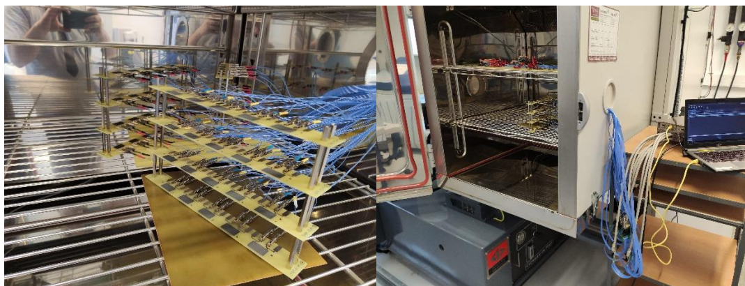
Obr. 5.1: Umístění vzorků do klimatické komory pro kalibrační měření. Vlevo detail vnitřního rozmístění v komoře, vpravo pohled na komoru a vyvedenou kabeláž
