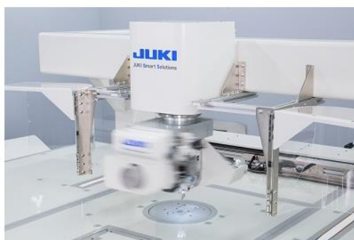
Obrázek 3: CNC šicí stroj AMS-251
