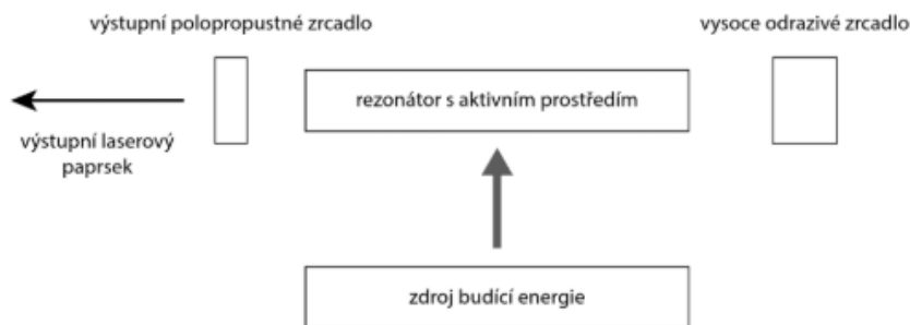
Obrázek 5: Hlavní součásti laseru
