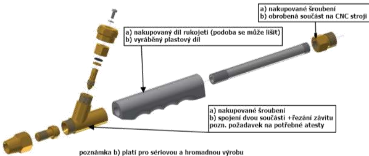
Obrázek 4-4 Stávající stavební struktura TS - plynový hořák [Sasiadek 2016]
