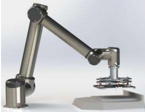
Obrázek 15-14 Koncepční a konstrukční řešení upínací desky [zdroj autor]
