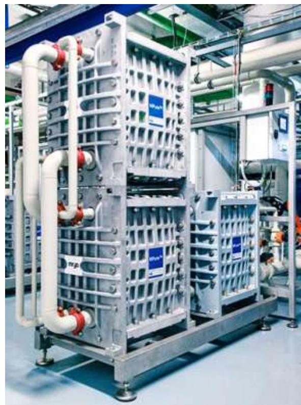
Obrázek 5-2 Vyrobený EDI modul: samotný modul (vlevo), „stack“ provedení (vpravo) [zdroj Mega 2019]
