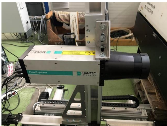
[Obr. 20] Přípevnění LDA k traverzéro
