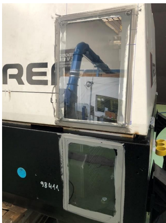
[Obr. 17] Optický přístup skrze skřín kompresoru
