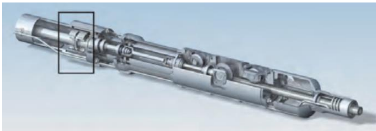
Obr. 13 Řez regulačního orgánu s vyznačenou polohou čelisti [7]
