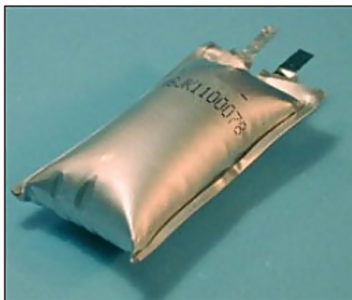
Obr. 1.9: Měkký prizmatický článek při poruchovém stavu [Převzato z [7]]
