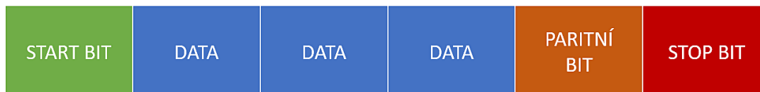
Obr. 5.1: Standardní tvar rámce UART |Převzato z [23]|
