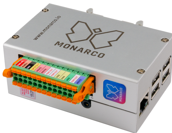
Obr. 3.2: Monarco HAT a počítač Raspberry Pi v hliníkové krabičce [8]
