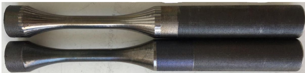
Obr. 38 Grafické znázornění ohnutí vzorků po aplikaci zvolených parametrů
