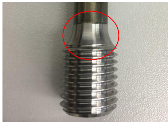
Obr. 46 Napojení rádiusu na laserovanou plochu
