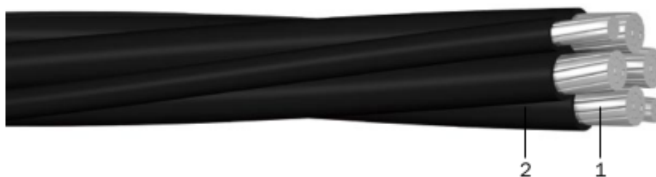
Obrázek 5.1: Závěsný izolovaný vodič AES. 1)Al jádro (RM), 2)Izolace (PE černý, odolný proti UV záření), žíly jsou stočené do duše.
