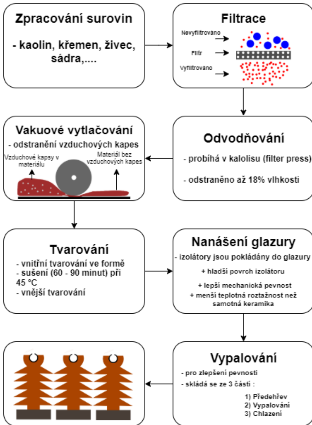
Obr. 6: Výroba keramických izolátorů
