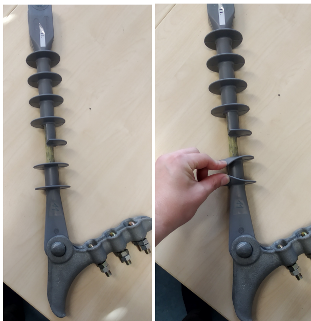
Obr. 5: Izolátor z kompozitního materiálu
