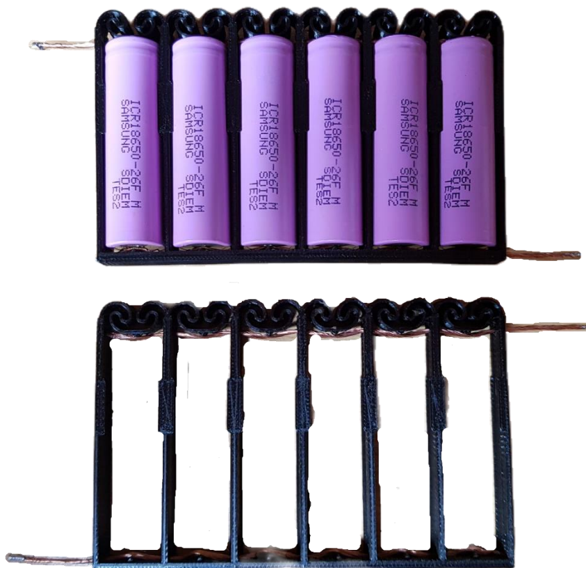
Obr. 19: Vytištěný držák na 6 kusů akumulátorů 18650
