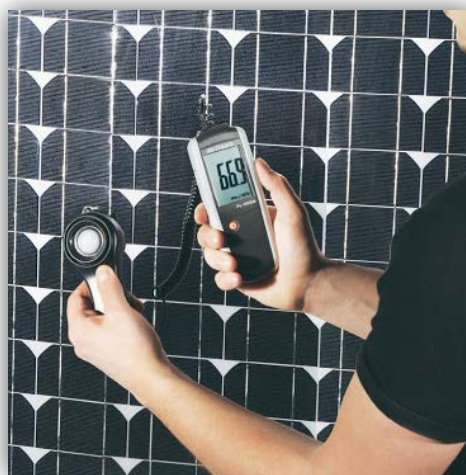
Obrázek 6: Měření intenzity osvětlení (osvětlenosti) [15]
