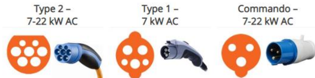
Obr. č. 14 - Zobrazení konektorů pro rychlé nabíjení [26]
