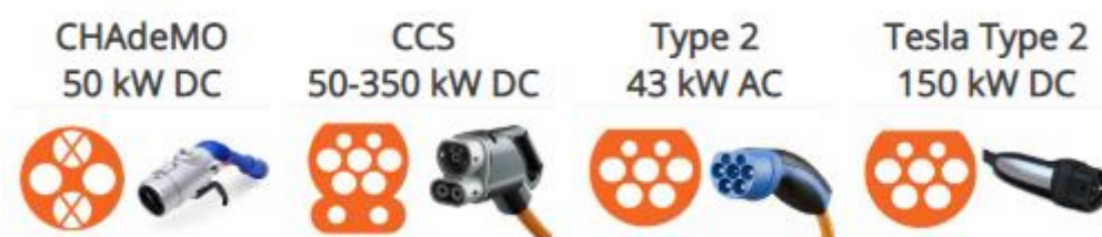
Obr. č. 13 - Zobrazení konektorů pro velmi rychlé nabíjení [26]
