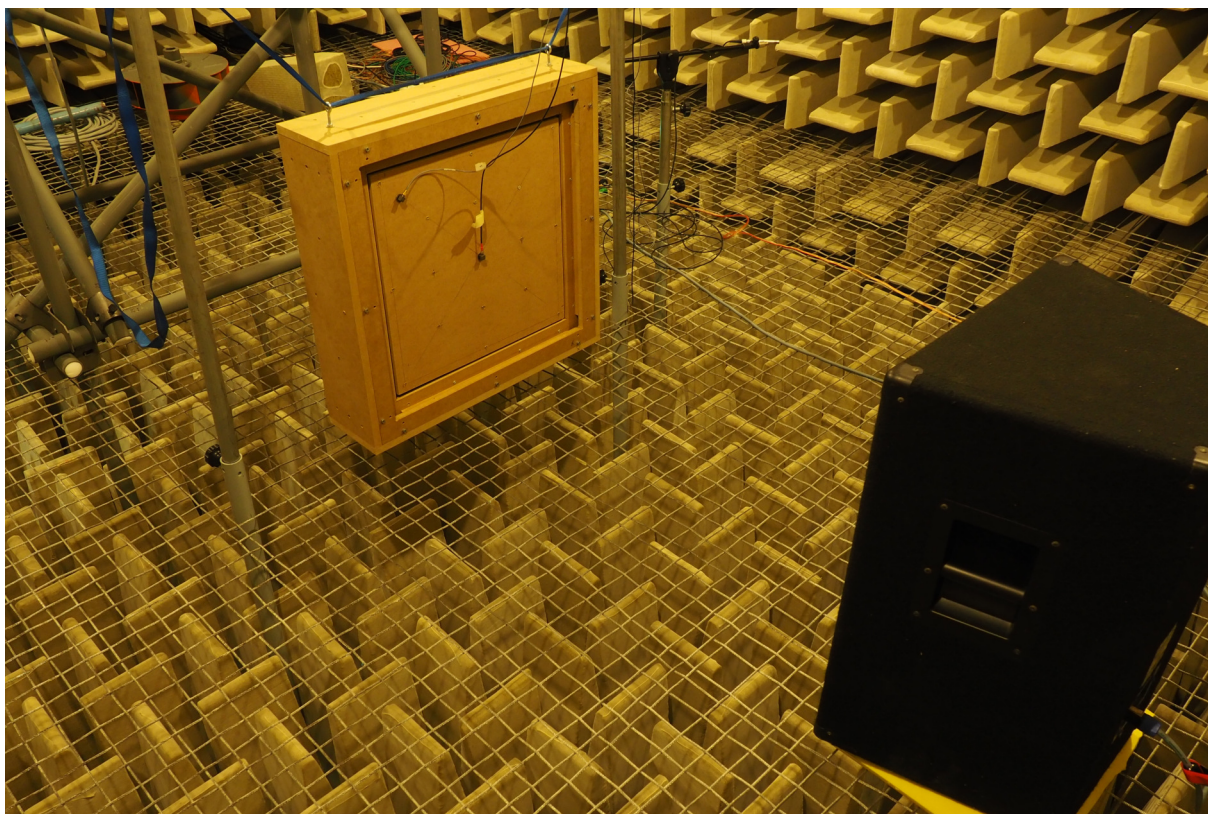
Obr. 6.4: Rozmístění přípravku a zdroje buzení v bezodrazové komoře
