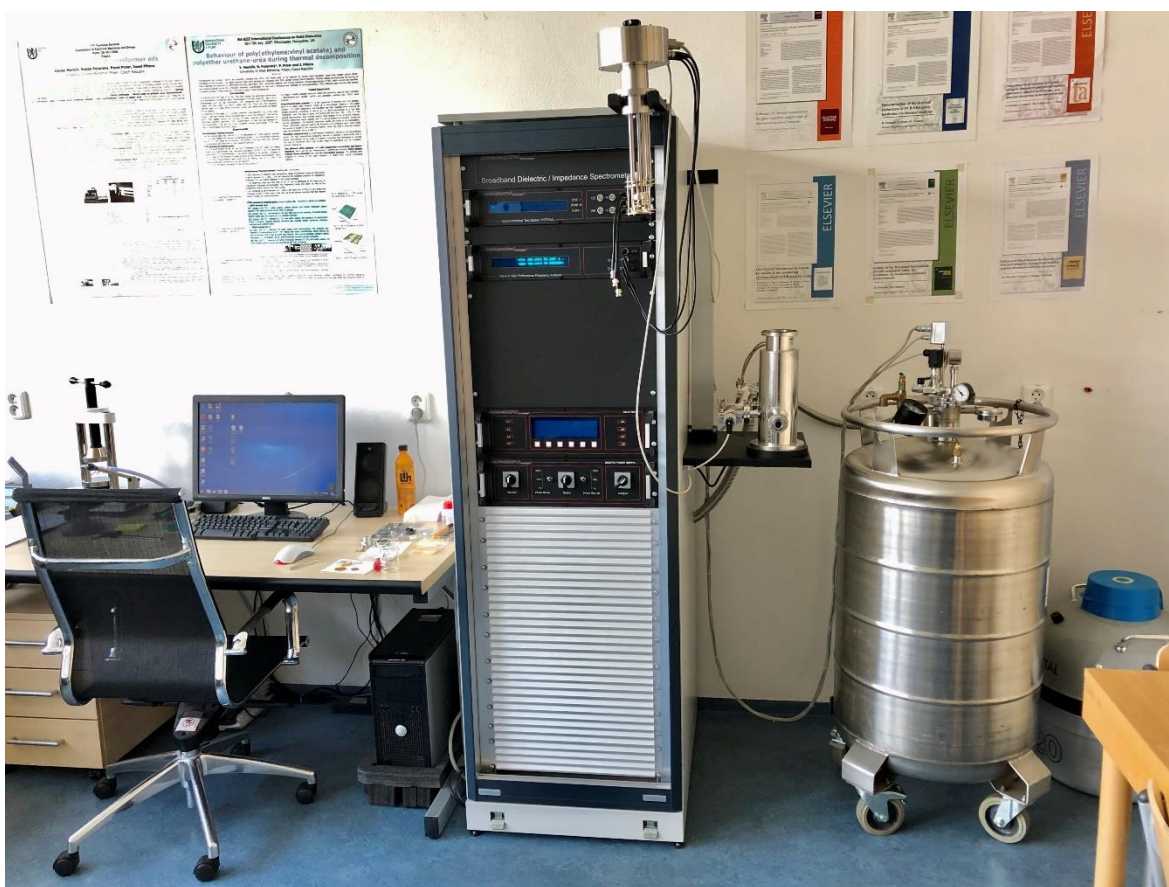
Obr. 19: Pracoviště pro měření technikou širokopásmové dielektrické spektroskopie.
