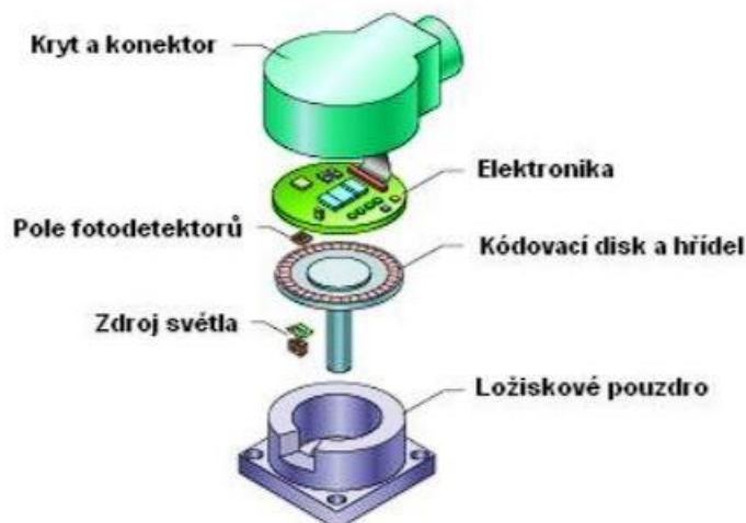
Obr. 2: Jednotlivé části inkrementálního rotačního senzoru
