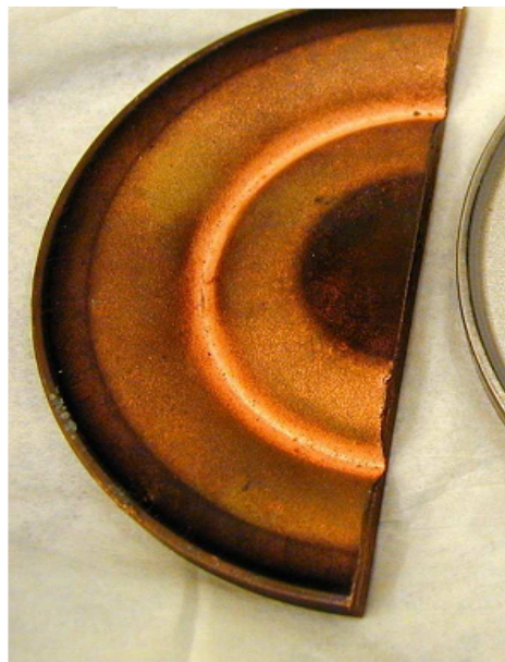
Obr 2.7 Terč znázorňující erozi terče ve tvaru “racetrack” [6]
