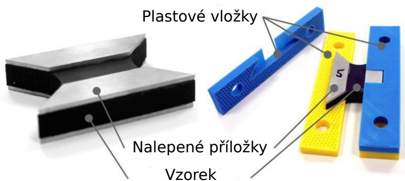
Obrázek 6.11. Vzorek typu Arcan s nalepenými kovovými příložkami a plastové vložky do přípravku
