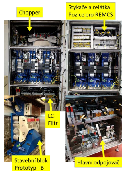
Obr. 69 - Výzbroj skříně s výkonovými měniči – soustava základních stavebních bloků 150 kVA
