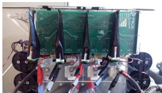
Obr. 58 - Sepnutí tranzistorů pomocí 9 V baterie
