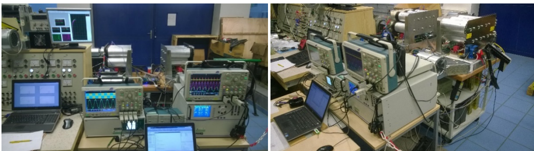
Obr. 46 – Laboratorní stanoviště pro back-back testování výkonových měničů 150 kVA
