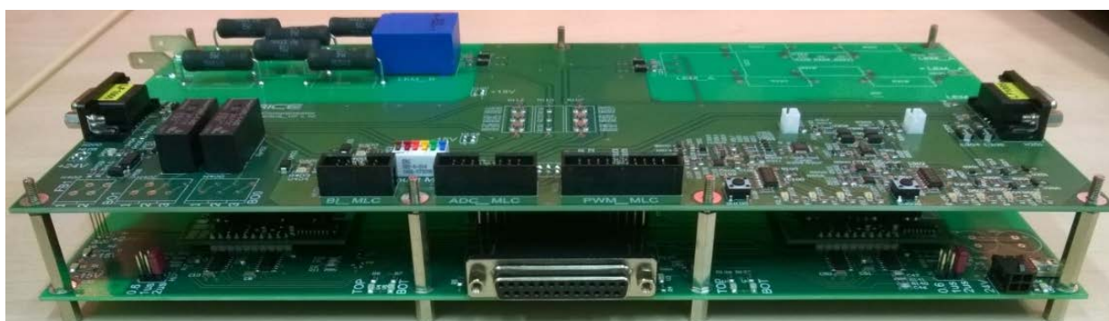
Obr. 41 - Budičící obvody s přizpůsobením pro MLC interface i řídicí kartu
