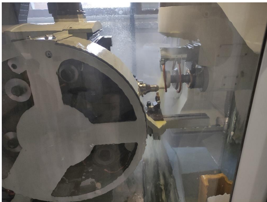
Obr. 16: Broušení válečku z SK pomocí brusky ANCA MX7
