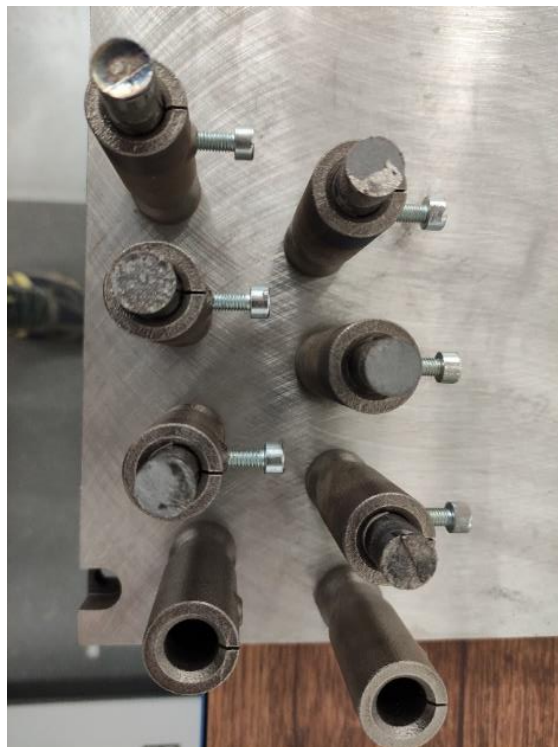
Obr. 24: Válečky ze SK s natištěným materiálem MS1
