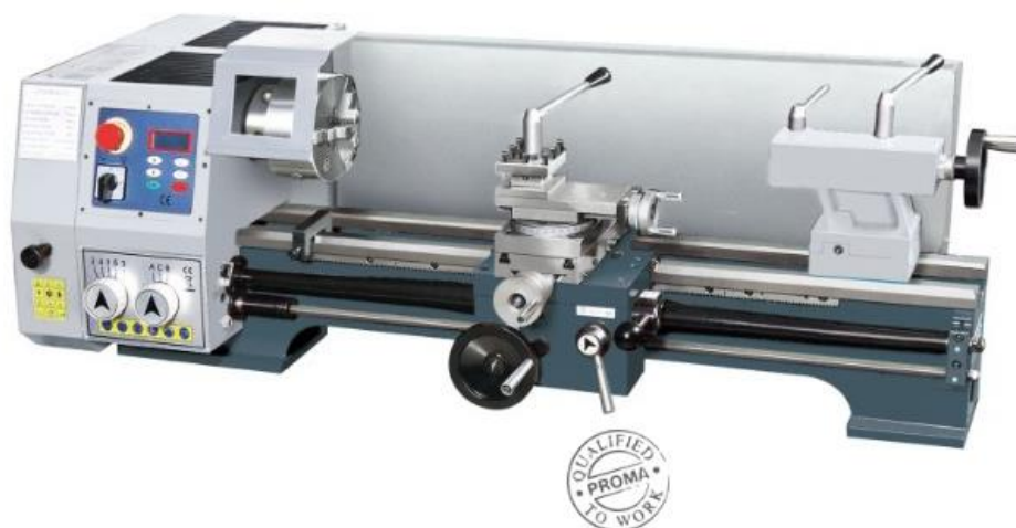
Obrázek 6 – Univerzální soustruh SPB 700V/230 s variátorem [12]
