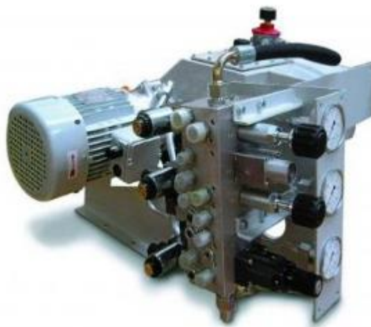
Obrázek 7 Hydraulická jednotka kotoučové pily s elektromotorem 1,5 kW, dvojitým čerpadlem o celkovém průtoku 10 dm 3 /min 1 pro pracovní posuv a rychloposuv. Jednotka v plném osazení ovládá dva svěráky, podávání materiálu a přísuv pily do řezu. [14]
