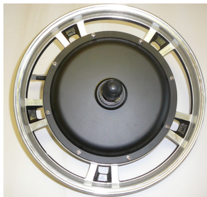
Obrázek 30 - BLDC motor 750-1000W, přední kolo 16" (60)
