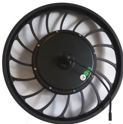
Obrázek 28 - Varianta 1: BLDC motor 750-1000W, přední kolo 20" (58)
