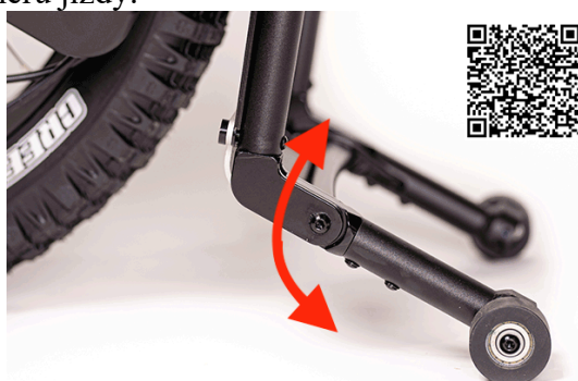
Obrázek 14 - Tlumení stojanu Batec Scrambler (12)
