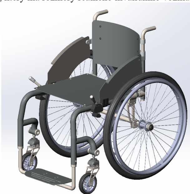
Obrázek 38 - Model sestavy invalidního vozíku (66)
