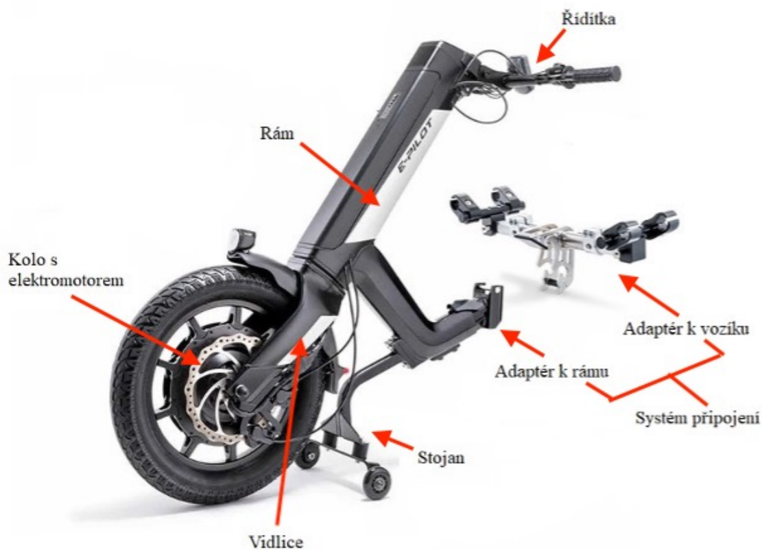
Obrázek 12 – Konstrukční celky elektropohonu – E-pilod od Alber (30)
