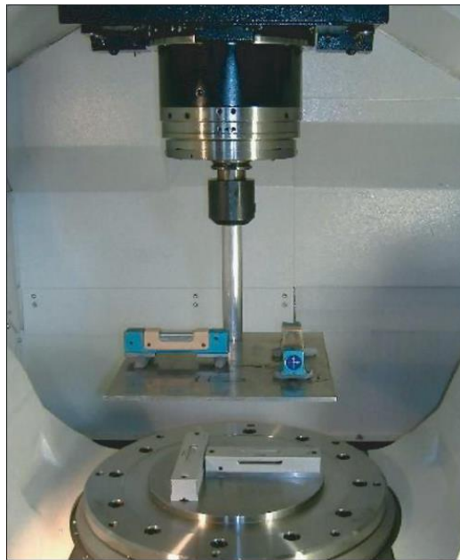
Obr. 2.16: Měření vodorovnosti ustavení stroje pomocí libely [14]
