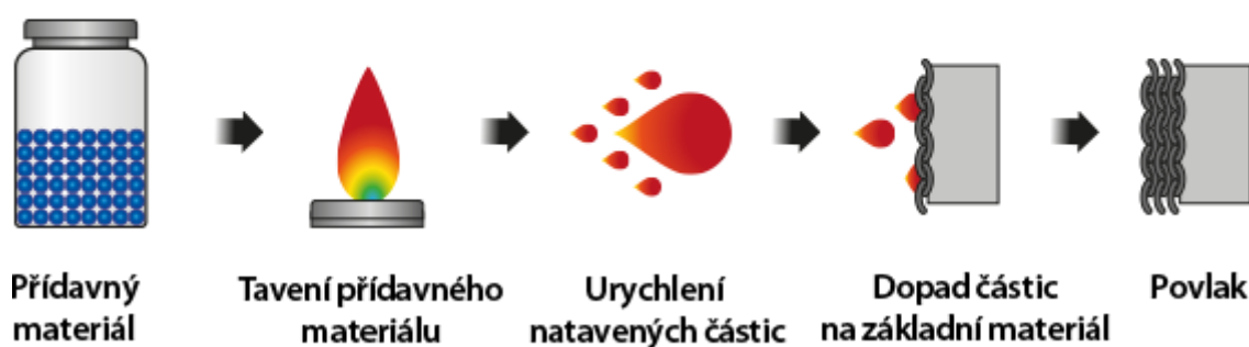
Obr. 1 Proces žárového nástřiku [1]
