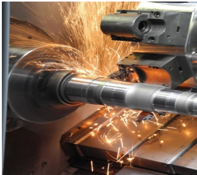
Obr. 34 HSC soustružení nástrojem s VBD z CBN [35]
