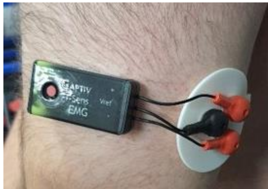
Obrázek 6-1 Umístění EMG senzoru (zkušební měření)
