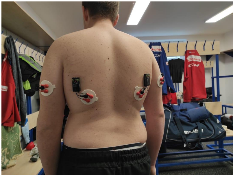
Obrázek 6-7 Umístění EMG senzorů (pro ostré měření)
