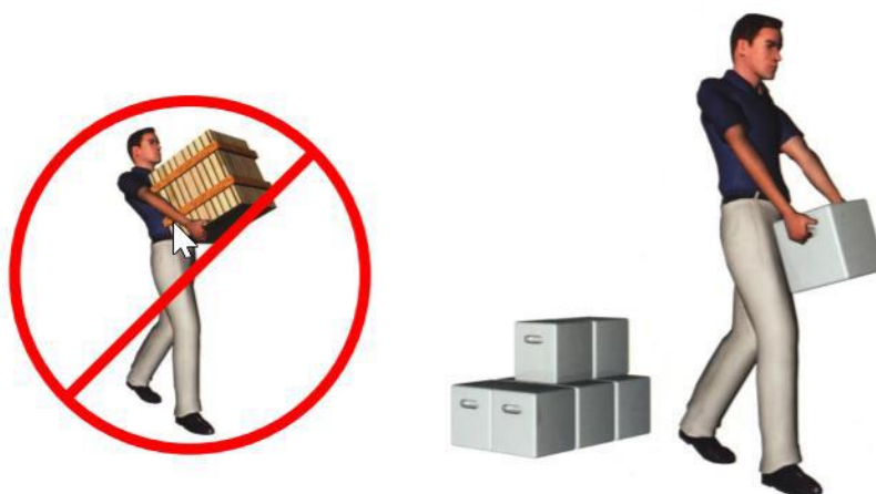
Obrázek 1-20 Manipulace s břemeny-zmenšení hmotnosti nákladu [9]
