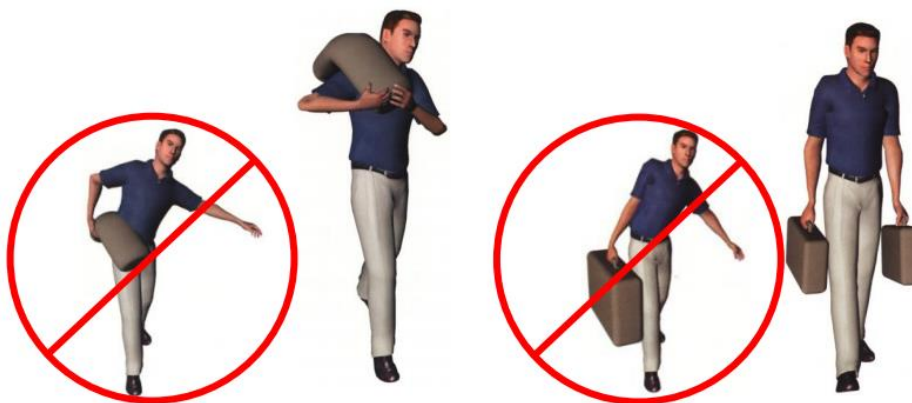
Obrázek 1-15 Manipulace s břemeny – symetrické zatížení [9]
