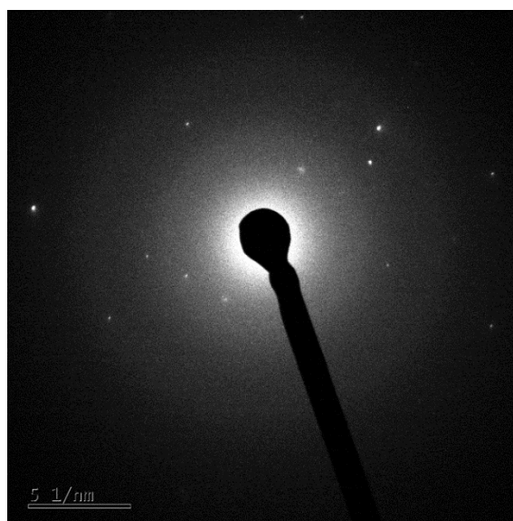
Obr. 37: Difraktogram částic depozitu \text{CaTiO}_3 naměřený pomocí elektronové difrakce na HRTEM.
