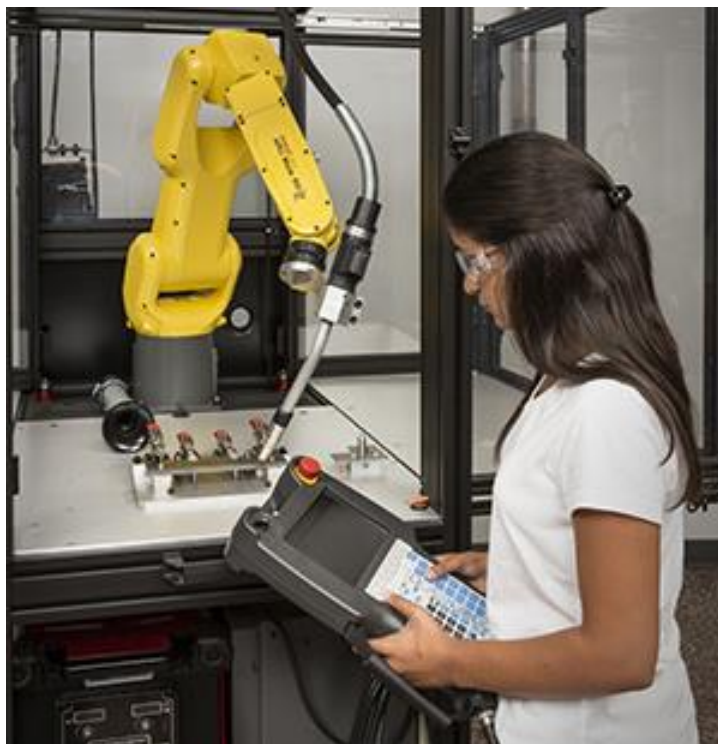
Obr. 8 – Proces on-line programování svařovacího robota [26]
