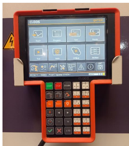
Obr. 9 – Programovací konzole svařovacích robotů firmy IGM [18] vlevo a firmy CLOOS vpravo
