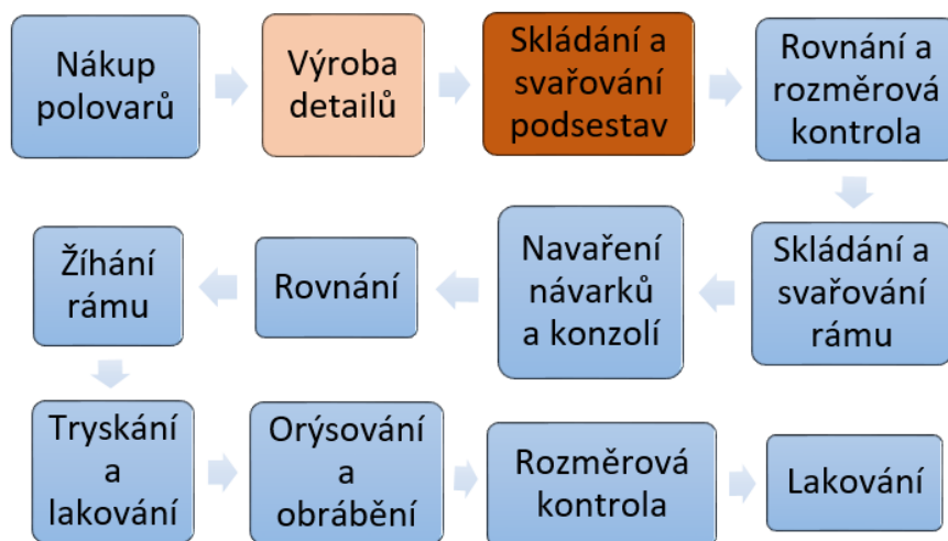
Schéma 2 - Výroba svařovaného rámu podvozku kolejového vozidla
