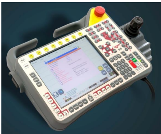
Obr. 9 – Programovací konzole svařovacích robotů firmy IGM [18] vlevo a firmy CLOOS vpravo
