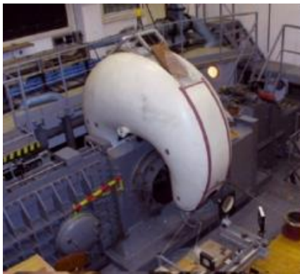
a) Celkový pohled na tunel s upořádáním pro optická měření ve vysokorychlostní laboratoři v Novém Kníně
