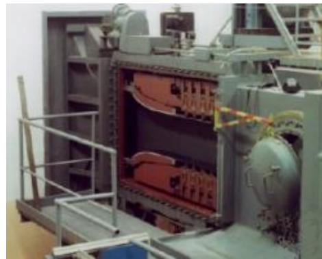
b) Deformovatelná vstupní dýza tunelu
