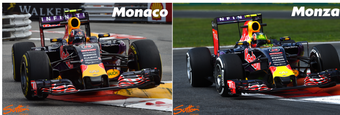
Obrázek 4 Srovnání nastavení zadního křídla vozu F1 pro různé okruhy [9]
