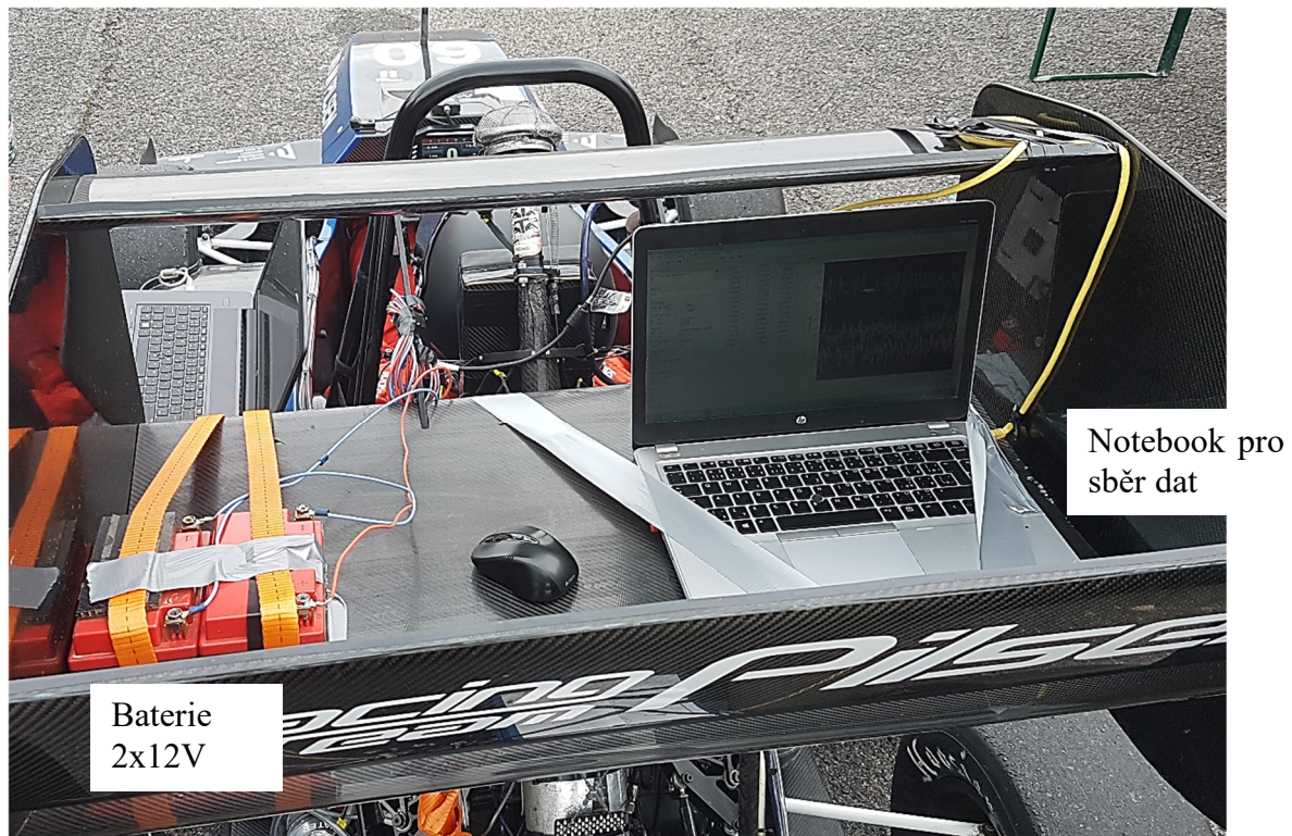
Obrázek 17 Umístění počítače a baterií na křídle vozu
