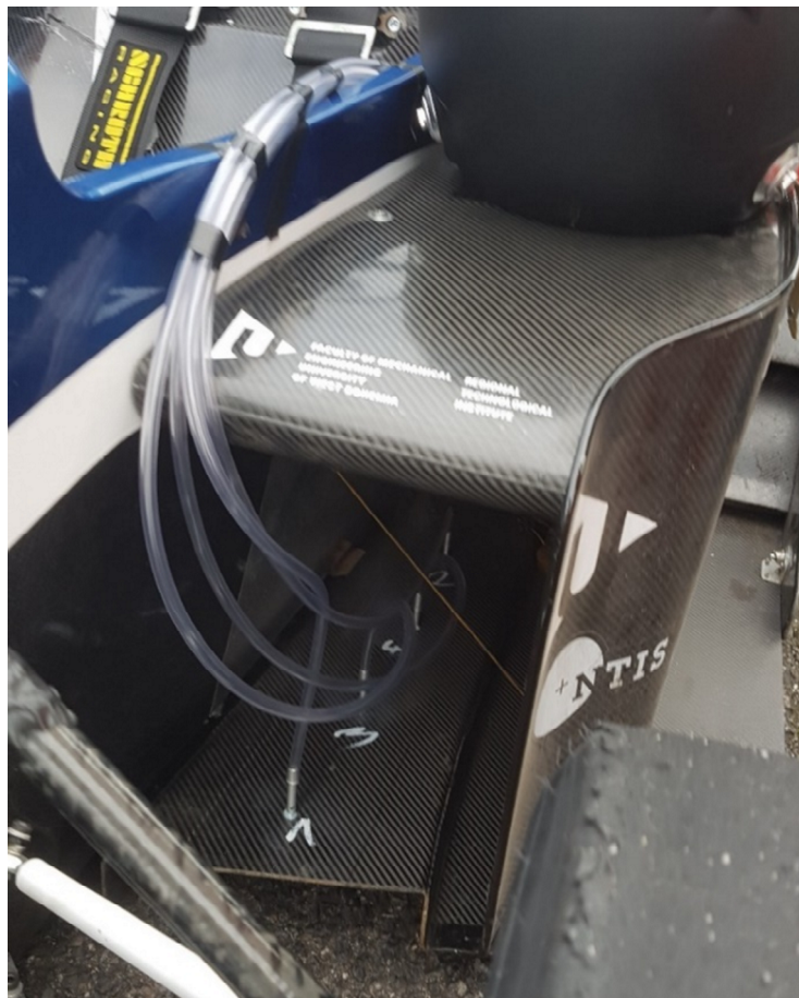
Obrázek 22 Odběrové pozice v první části levého kanálu
