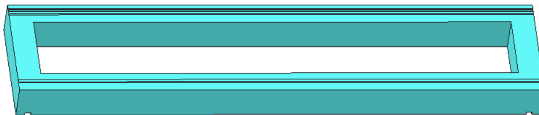
Obrázek č. 30 Most manipulátoru horké komory
