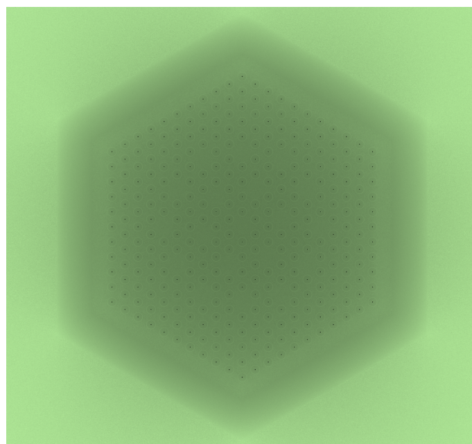
Obrázek č. 37 Rozložení neutronového toku palivového souboru se stíněním
