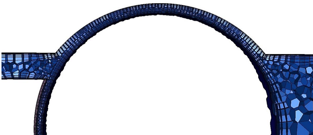
Obrázek 24 - Detailní řez jednou polovinou výpočetní sítě pro Geometrii 2
