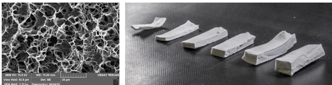
Obrázek 5: Snímek struktury hydrogelu ze skenovacího elektronového mikroskopu (vlevo) a polyakrylamidové hydrogely po lyofilizaci (vpravo)
