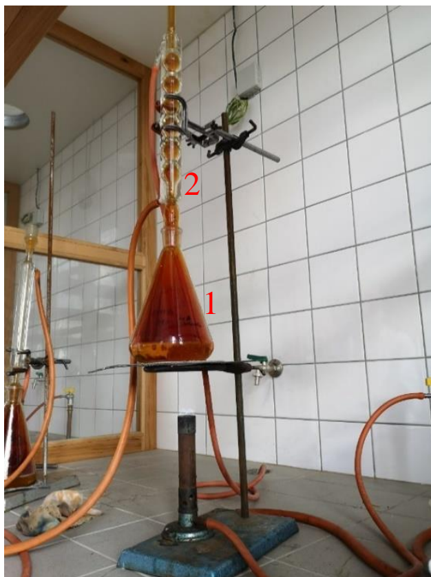
Obr. 20 Zahřívání Erlenmeyerovy baňky po nadávkování cyklohexanolu
