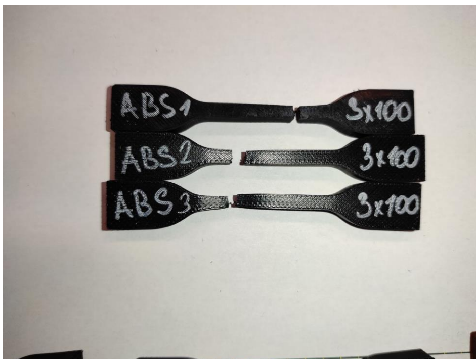
Obrázek 18 Viditelné vytvoření krčku u vzorků ABS-T se 100 % výplní
