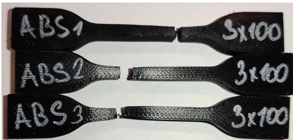
Obrázek 21 Detail přetrhaných vzorků ABS-T s plnou výplní
