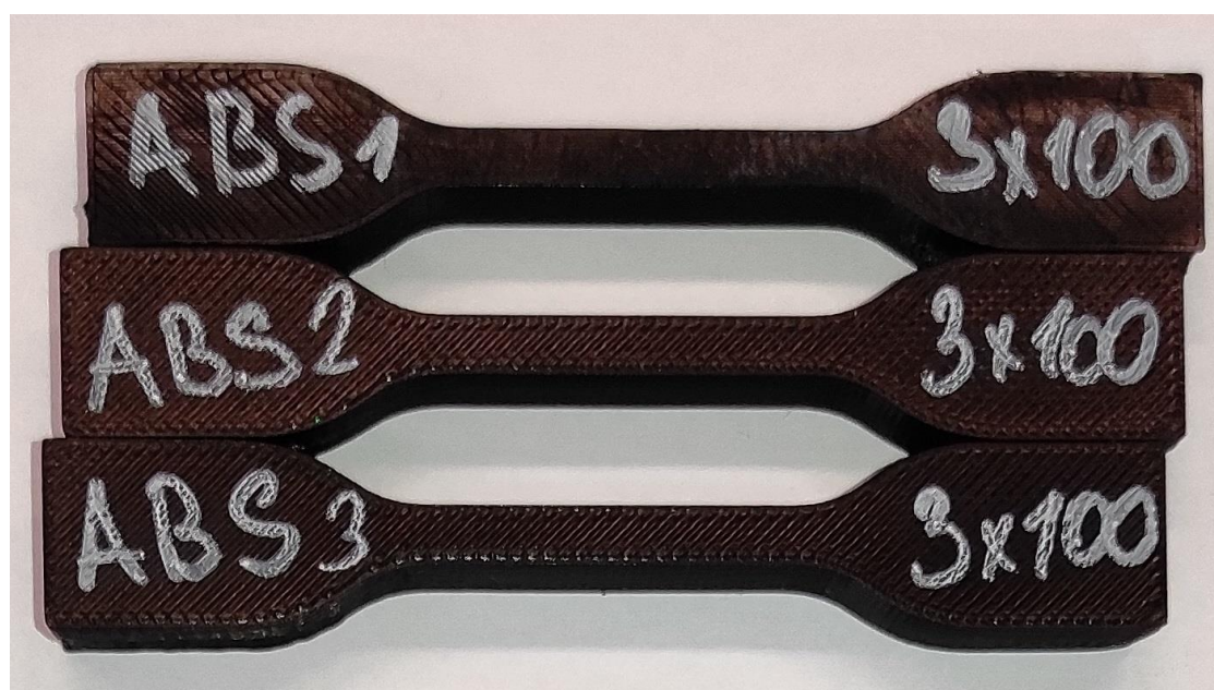
Obrázek 20 Detail nepřetrhaných vzorků ABS-T s plnou výplní
