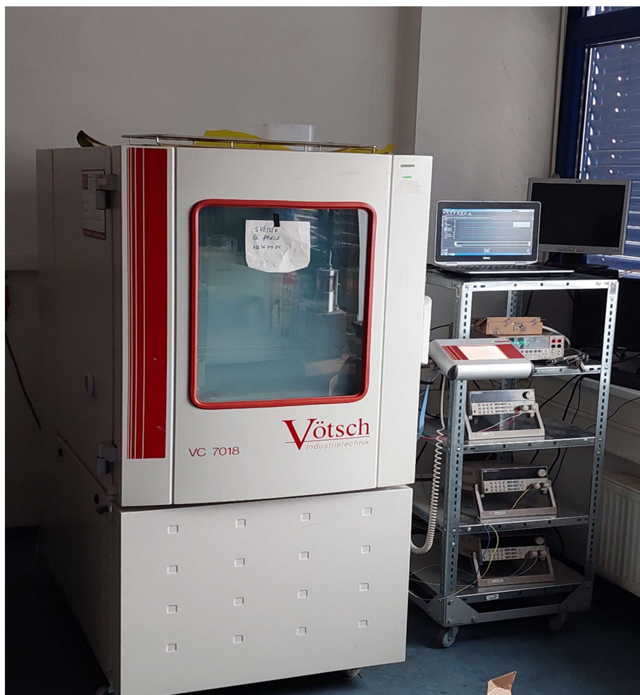
Obr 4.2: Měřicí sestava a klimakomora
