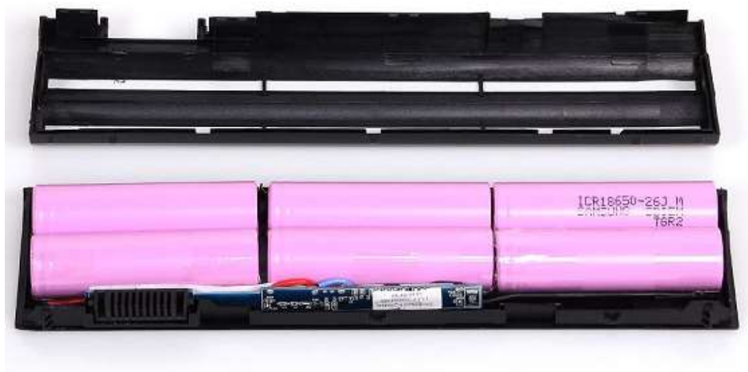
Obr 3.5.: Složení náhradní baterie od firmy Lenoge pro notebooky DELL. Jak je vidět, je složena ze článků Samsung ICR18650-26J a z obvodu zajišťující správné nabíjení a vybíjení. [43]
