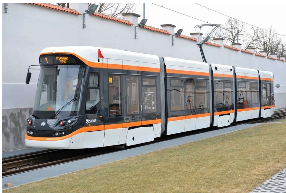
Obr 3.4.: Tramvaj 18T od Škody Transportation pro turecké město Eskişehir, která pro jízdu mimo trolej používá akumulátory LTO od firmy Altair nanotechnologies. Udávaný dojezd na baterie je do 5 km. [39]
