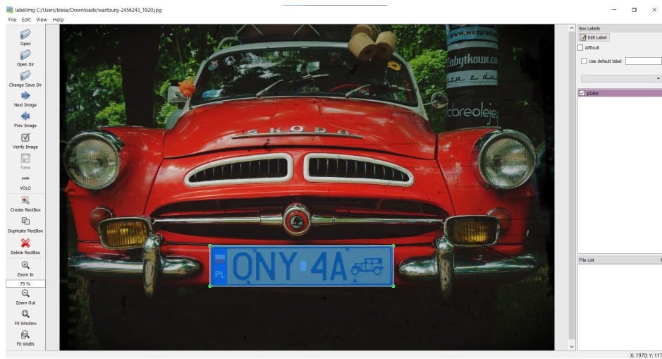
Obr. 14: Vytvoření labelu registrační značky v LabelImg s výstupem pro YOLO na obrázku automobilu [49].
