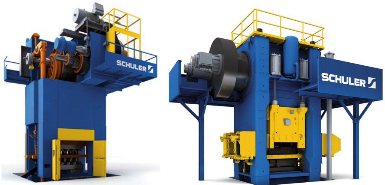
Obrázek 4-3 - Schuler – vlevo lis s klasickým pohonem, vpravo lis se servomotory [12]
