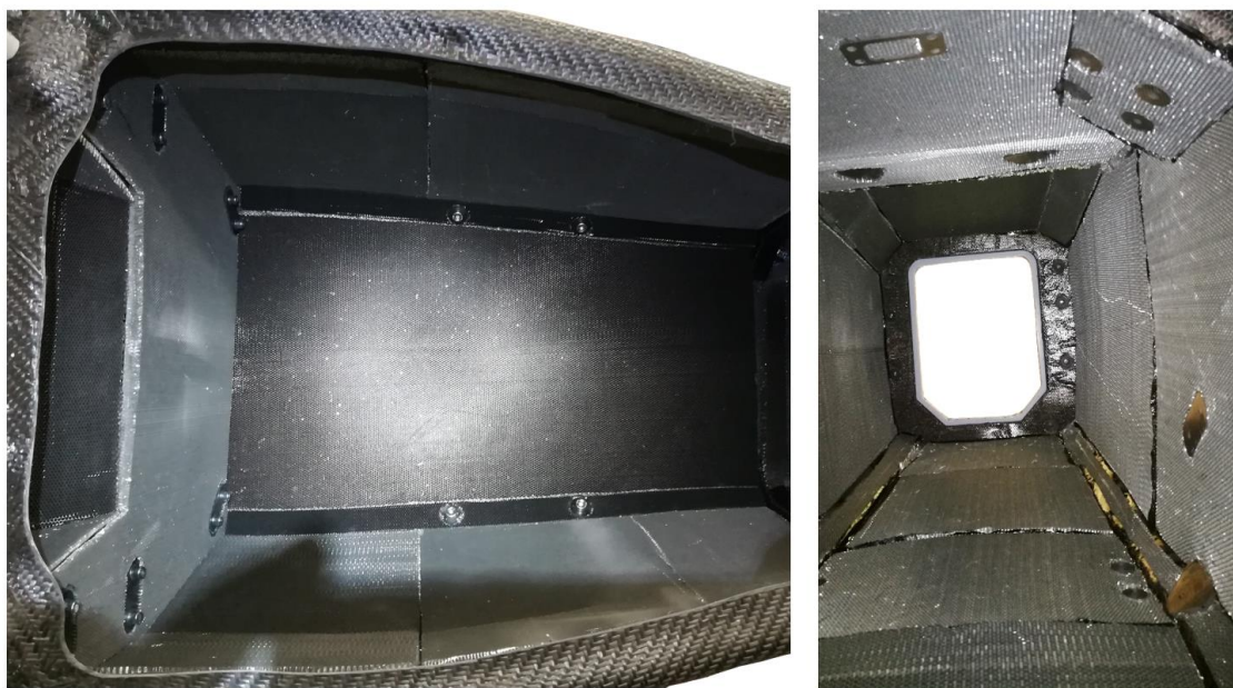
Obrázek 9-12 Operace č. 49 - Vkládání jádra, vlevo prostor kokpitu, vpravo prostor nohou
