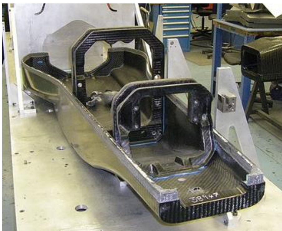
Obrázek 4-7 Spodní polovina lepeného skořepinového rámu [38]
