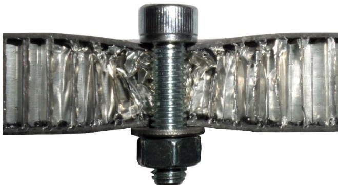
Obrázek 5-53 Lokální zborcení jádra ve šroubovém spoji kompozitního sendvičového panelu
