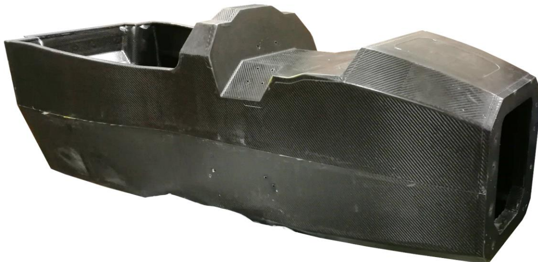
Obrázek 9-16 Skořepinový rám po vyjmutí z formy
