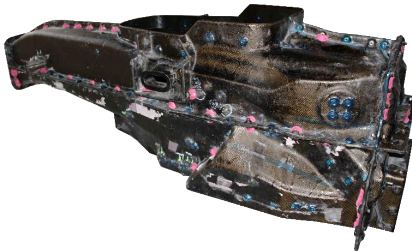
Obrázek 7-27 Dvanácti-dílná forma vozu Formula 1 [70]
