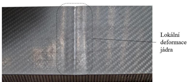
Obrázek 5-48 Boční pohled na lokální porušení jádra v tlaku pro vzorek Ohyb_P[4]_C[3,2/72]
