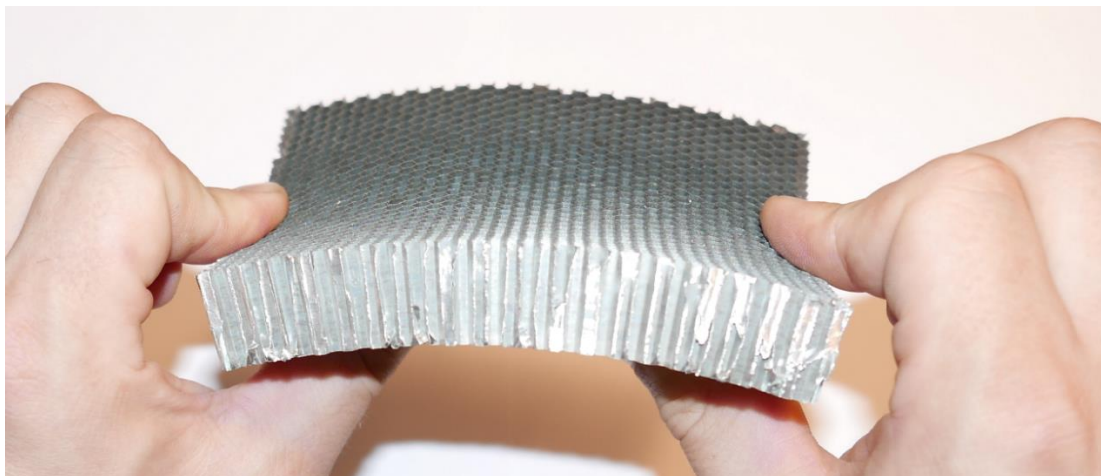
Obrázek 5-4 Deformace voštiny při ohýbání v jednom směru
