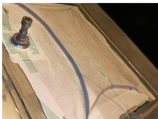
Obrázek 5-35 Zborcené jádro sendvičového kompozitního panelu po vytvrzení s vnějším tlakem 3 bar
