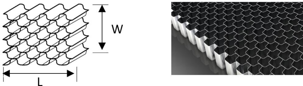
Obrázek 5-7 Voština "FlexCore" s vlnkovitým tvarem jádra
