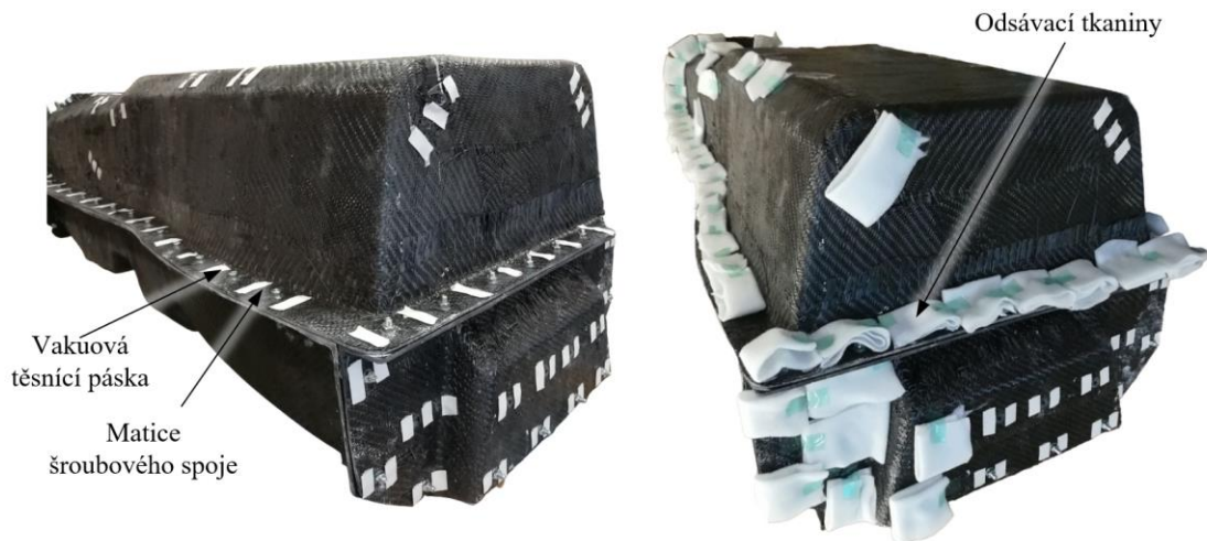
Obrázek 9-7 Operace č. 33 - Využití odsávací tkaniny na překrytí šroubových spojů, vlevo před aplikací odsávací tkaniny, vpravo průběh aplikace odsávací tkaniny
