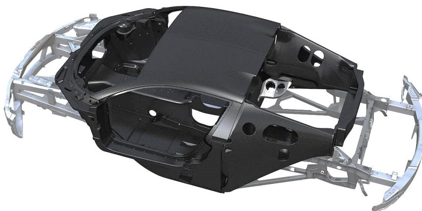
Obrázek 2-11 Skořepinový rám vozu Bugatti Veyron 16.4 [14]
