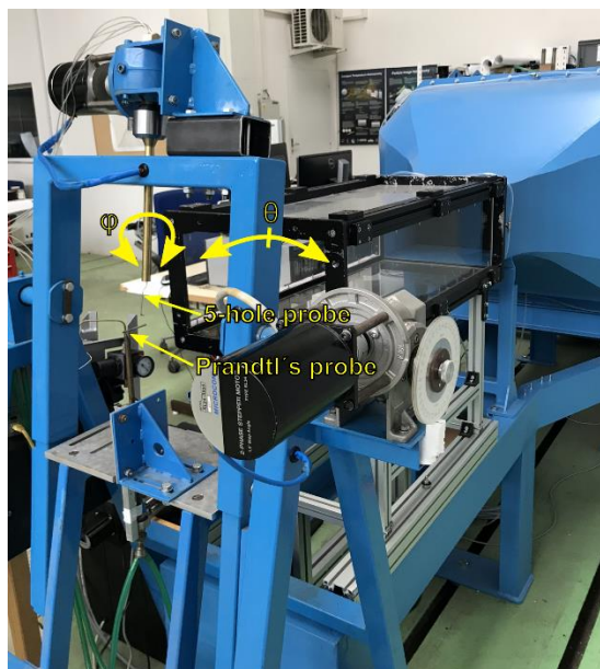
Obrázek 4-11 – Detail traverzovacího systému (vlevo); označení a orientace úhlů pěti-otvorové sondy (vpravo) [29]
